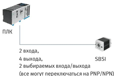
Самый простой способ подключения датчика технического зрения SBSI к контроллеру для вывода результатов соответствия/несоответствия посредством входных/выходных сигналов. Эжекторы также могут быть подключены непосредственно к источнику энергии (100 мА, 24 В).
