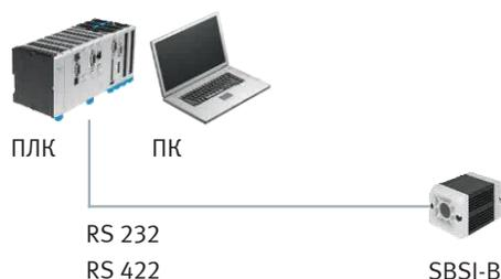
Считыватель кода SBSI-B также может быть легко и недорого подключен к ПК или контроллеру через последовательный интерфейс. Это означает, что интеграция с более старыми системами не является проблемой.
