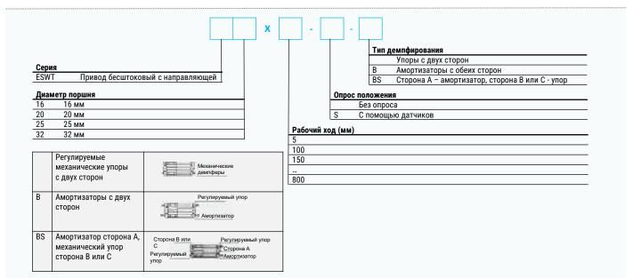
**Пример заказа:** Серия ESWT, диаметр поршня 20 мм, рабочий ход 500 мм, с опросом положения, с амортизаторами. Код заказа: **ESWT20x500-S-B**
