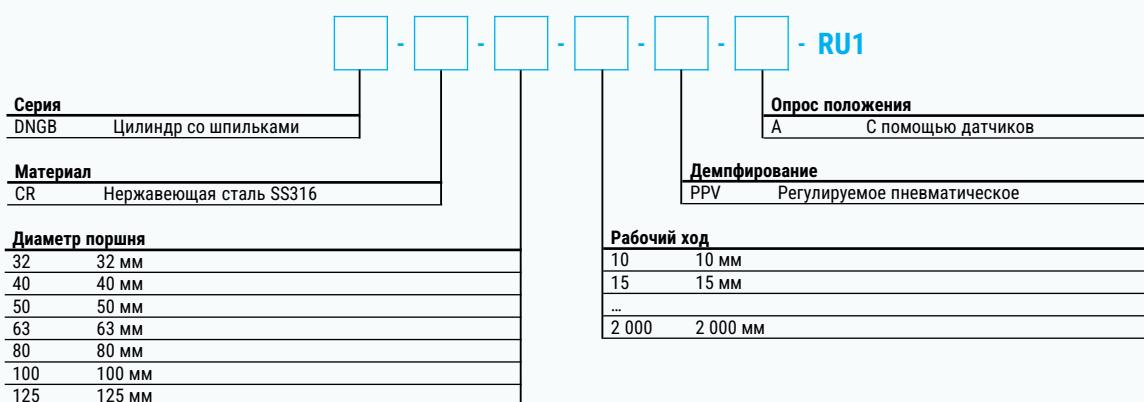
**Пример заказа:** серия DNGB-CR, из нержавеющей стали, диаметр поршня 63 мм, рабочий ход 200 мм, регулируемое демпфирование, опрос положения.
