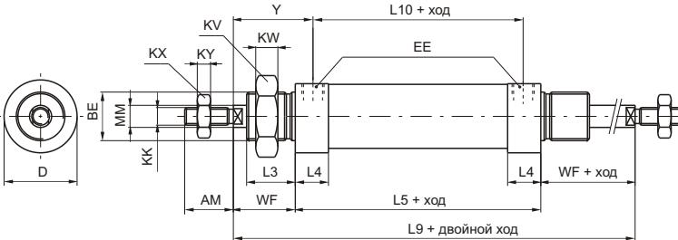
Все размеры данного исполнения, за исключением штока проходящего сквозь обе крышки, идентичны модели 1260. Данное исполнение недоступно для цилиндров с диаметром поршня 8 мм и 10 мм. Для заказа скоб и магнитных датчиковсмотрите стр. 4-05/8.
