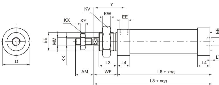
Данное исполнение получено из базового с целью уменьшения длины миницилиндра. Подвод сжатого воздуха выполнен в торце задней крышки или может быть сбоку. Ограничения для цилиндра в одностороннего действия аналогичны базовому исполнению. Данное исполнение не включено в стандарт ISO 6432. Для заказа скоб и магнитных датчиковсмотрите стр. 4-05/8.
