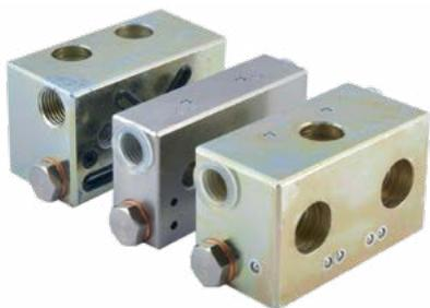
Система последовательного действия обеспечивает распределение и дозирование смазки золотниками, управляемые друг другом во взаимосвязанной последовательности. Золотники расположены гидравлически последовательно и поэтому несрабатывание одного из них вызывает остановку работы всей системы. Остановка системы случается также во время засорения выходных отверстий или когда неиспользуемое выходное отверстие заглушено.
