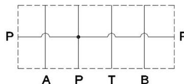
Условное обозначение на гидросхеме плиты EB605
