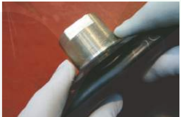
- Вдавите газовый клапан и прорезиненную прокладку к баллону 3.7v
