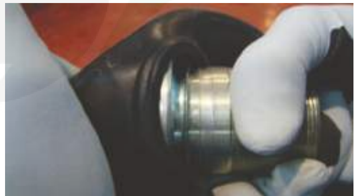
- Вытаскивайте газовый клапан, стягивая с него резиновый баллон
