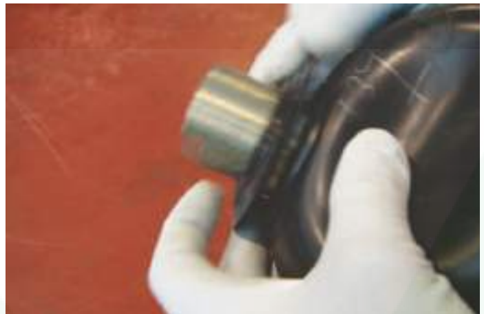
- Наденьте прорезиненную прокладку до конца клапана 3.7u
