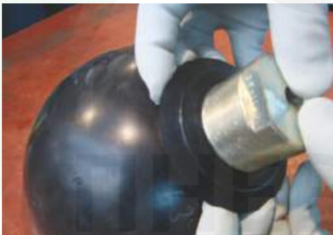
- Снимайте прорезиненную прокладку, стягивая ее по газовому 3.7m клапану
