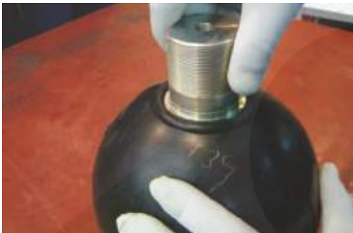
- Отрегулируйте положение корпуса газового клапана в баллоне 3.7s
