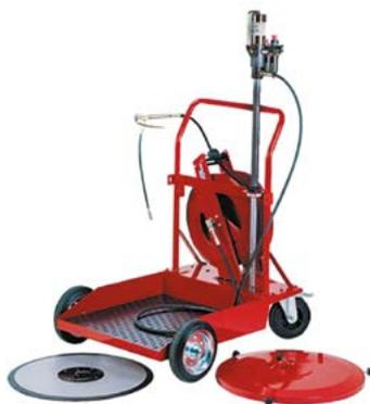
Комплект предназначен для перекачки пластичной смазки непосредственно из транспортных бочек в баки смазочных станций. Комплект также может использоваться для подачи смазки в смазочные точки или на вход блока питателей.
