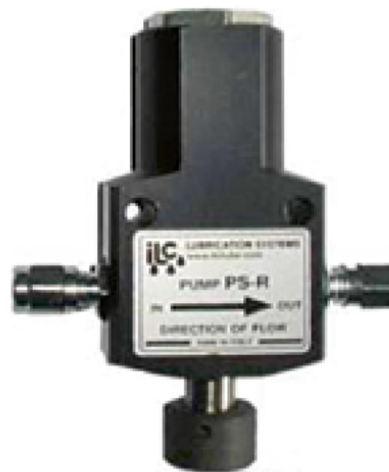
Плунжерный поршневой насос используется в дроссельных системах смазки, где имеется возможность привода насоса от подвижных механических частей оборудования. При нажатии на плунжер сжимается пружина и смазка всасывается внутрь насоса. Подача смазки в систему осуществляется под действием пружины. Данная модель часто используется с эксцентриком в качестве привода. Дополнительно заказываемый регулируемый эксцентрик позволяет точно задать требуемую подачу смазки.
