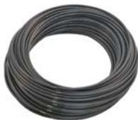
Применяется в системах микросмазки. Шланг совмещает в себе 2 трубки. Внутри шланга находится трубка меньшего диаметра, по которой транспортируется смазочный материал. По трубке большего диаметра транспортируется воздух. Смешивание смазочного материала и воздуха происходит по достижению распылительного наконечника.
